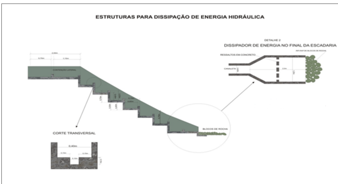
Figura 13 - Detalhe técnico escada hidráulica dissipadora de energia
