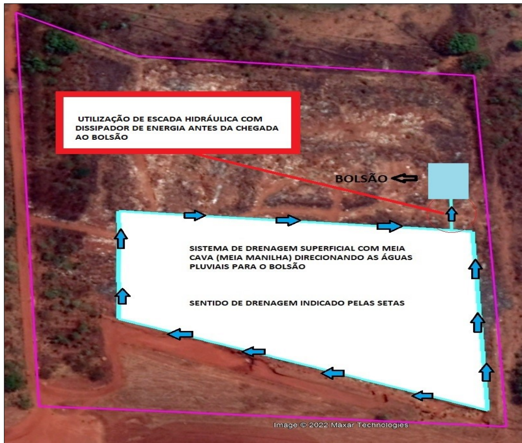
Figura 12 - Layout drenagem pluvial
