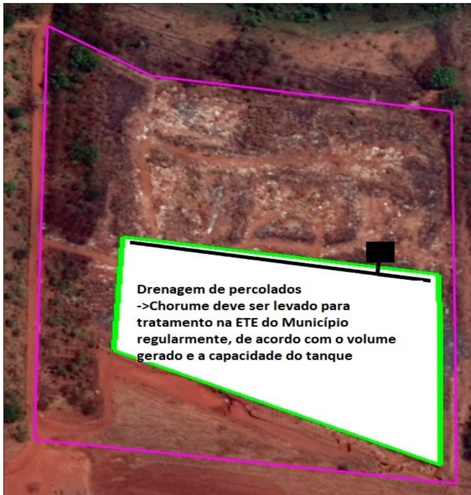
Figura 6 - Drenagem de percolados
