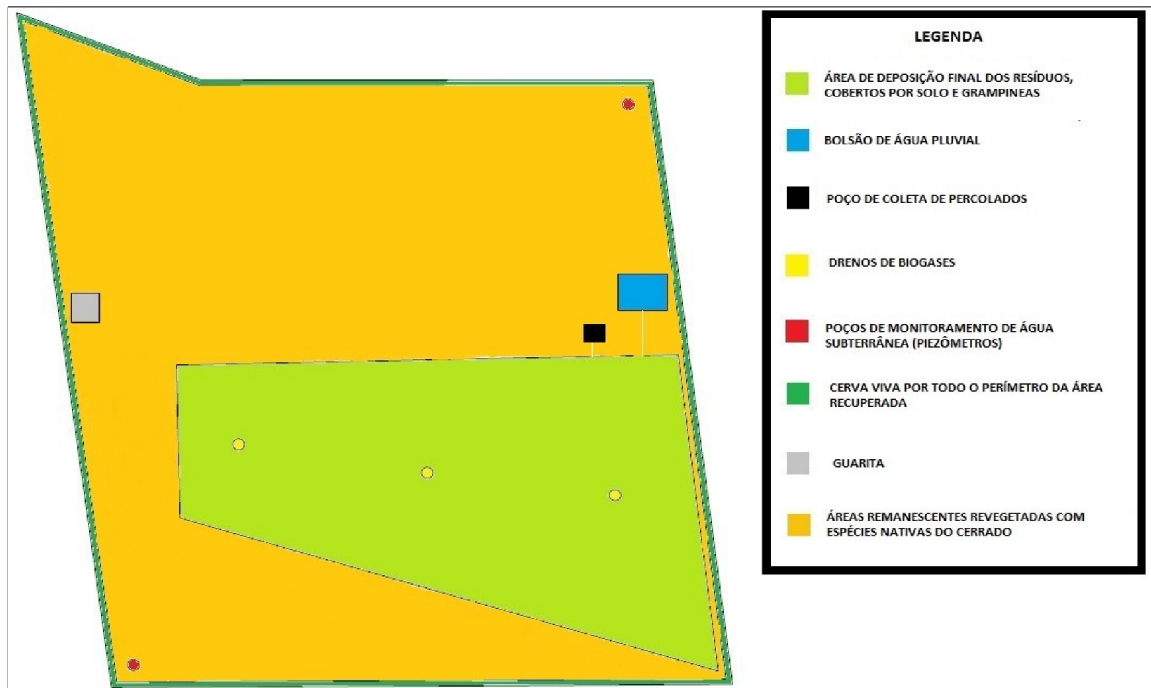
Figura 24 - Layout final das estruturas do projeto
