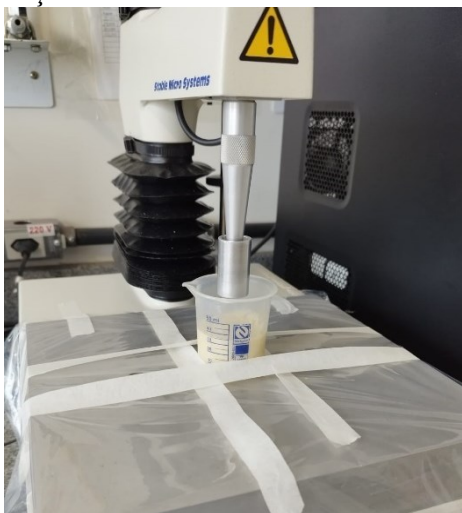
Figura 7. Avaliação de amostra de doce de leite no texturômetro
