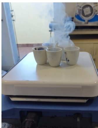
Figura 5. Processo de calcinação na chapa aquecedora
