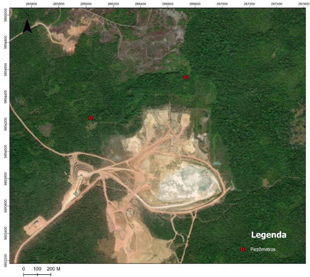
Figura 4.9 – Pontos para instalação dos piezômetros sugeridos.
