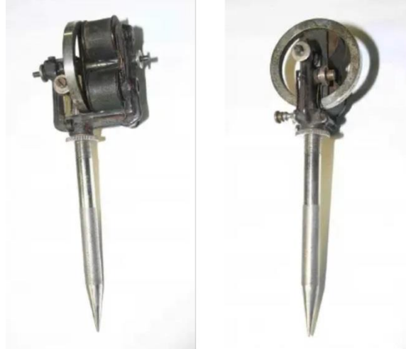
Caneta autographia ou impressora autográfica de Thomas Edison. Imagem retirada de “Tattoo Machine Exhibit”, disponível em: http://www.triangletattoo.com/machines.htm
