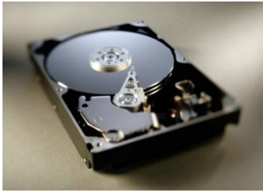
Figura 1.1 - Disco Rígido de computador possui componentes que são fabricados com usinagem de ultraprecisão.
