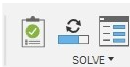
Figura 3.81 - Recurso de verificação das condições de contorno (botão da esquerda) e de execução da simulação (segundo botão da direita) do Fusion 360®.
