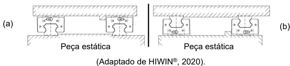
Figura 2.14 - (a) configuração de patins móveis e (b) configuração de patins fixos.
