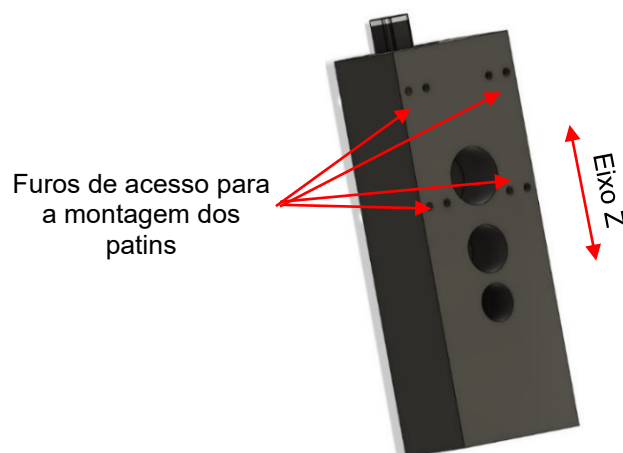
Figura 3.59 - Estrutura Z do protótipo 8 da minimáquina-ferramenta com furos de acesso de montagem dos patins e otimização do CG, em perspectiva.
