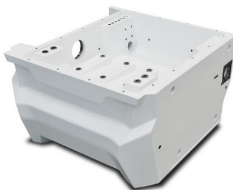
Figura 2.4 - Base da máquina-ferramenta Studer™ S11 construída de Granitan® S103.
