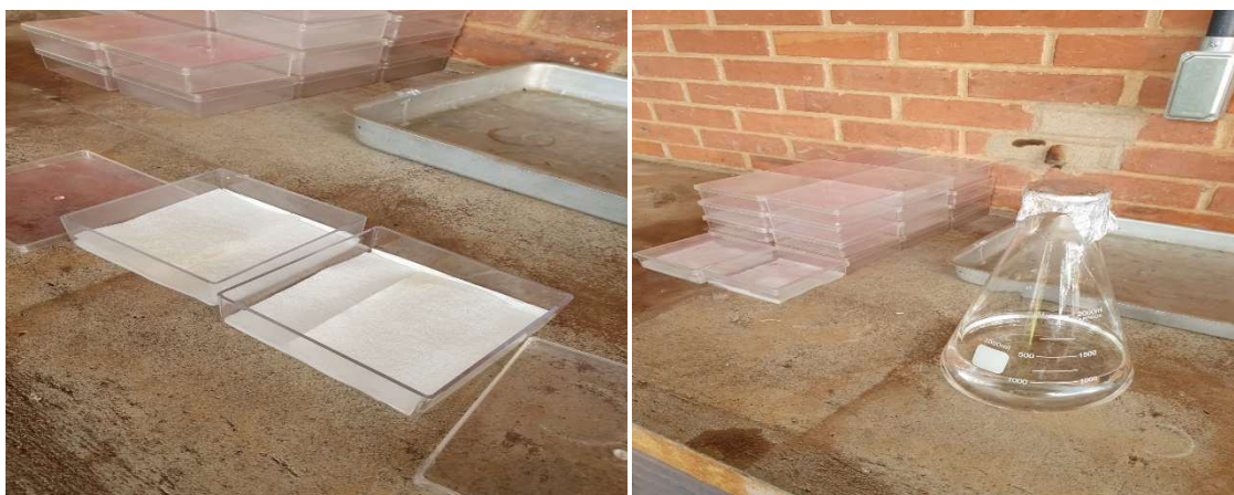
Figura 4- Método do papel filtro – Blotter test
