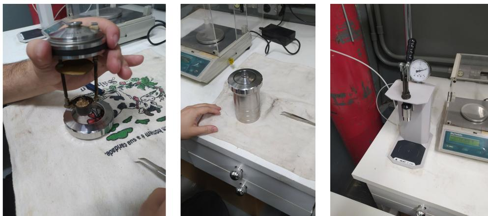
(a) Montagem para a queima (b) Frasco de Decomposição (c) Estação de preenchimento de oxigênio
