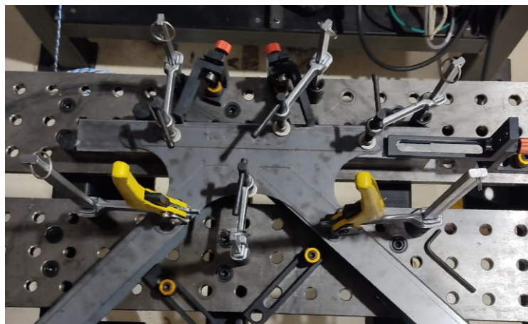
Figura 3.2 – Fixação do conjunto na bancada de ensaio.
