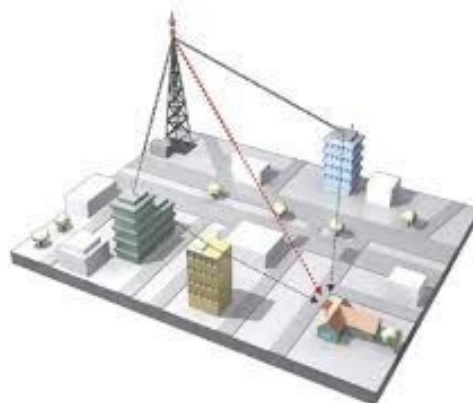
Figura 2.1 – Configuração de um enlace, com estação base (BS), e um dispositivo usuário (UE).
