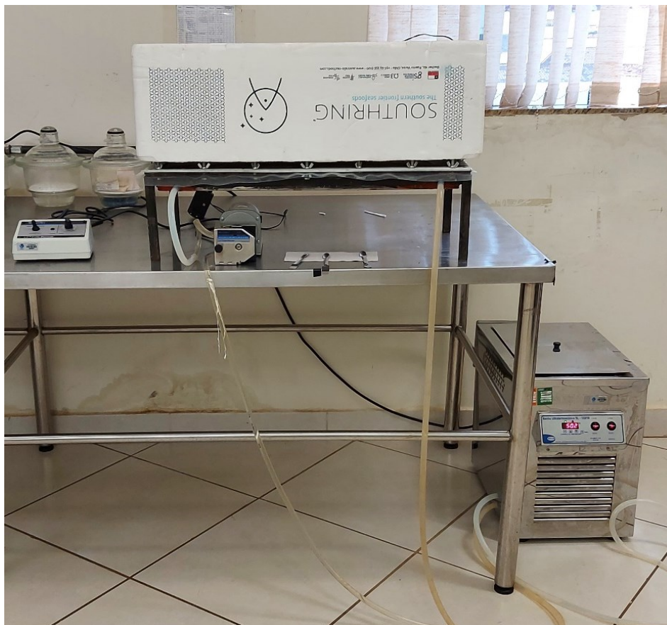
Figura 8 - Unidade Experimental de Secagem por cast-tape utilizada para a secagem do resíduo de cupuaçu.
