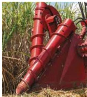
Figura 1 – Modelo de Separador de linha CASE IH (Colhedoras de Cana Case IH A 8810)
