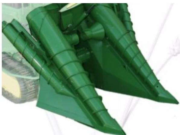
Figura 2 – Modelo de Separador de linha John Deere. (Colhedora de Cana 3520)
