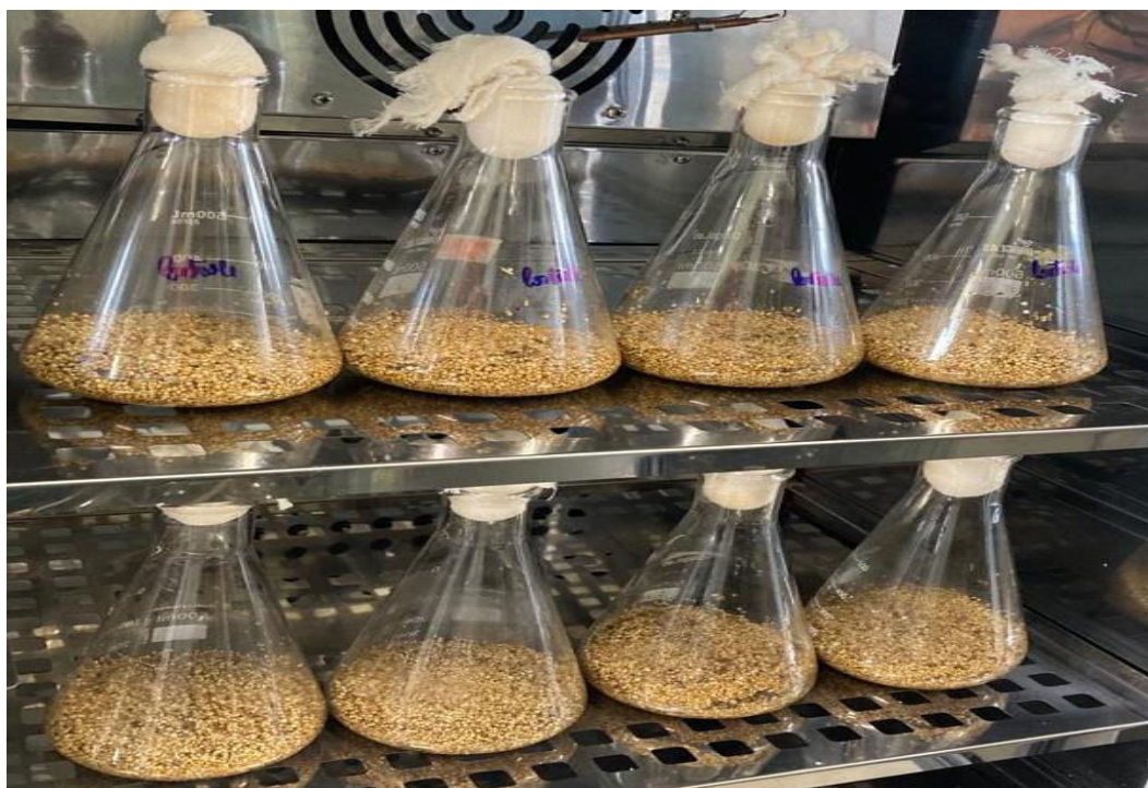
Figura 3.6 – Reatores estáticos na estufa BOD utilizando o substrato farelo de trigo.
