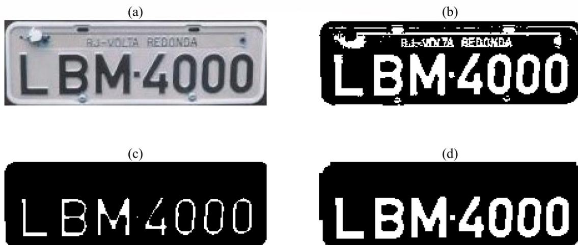
Figura 9 – (a) Imagem original representada por níveis de cinza. (b) Imagem binarizada. (c) Resultado do processo de erosão. (d) Resultado do processo de dilatação. Elaborado pelo autor.
