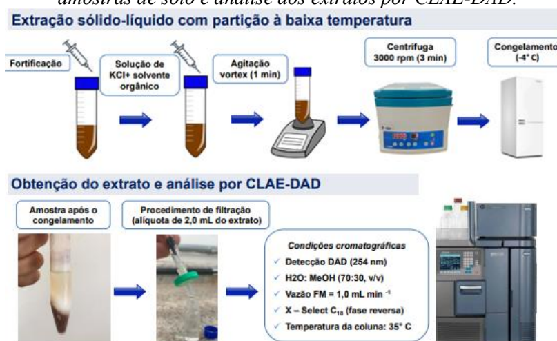
Figura 3. Fluxograma da extração sólido-líquido com partição à baixa temperatura do tiametoxam de amostras de solo e análise dos extratos por CLAE-DAD.
