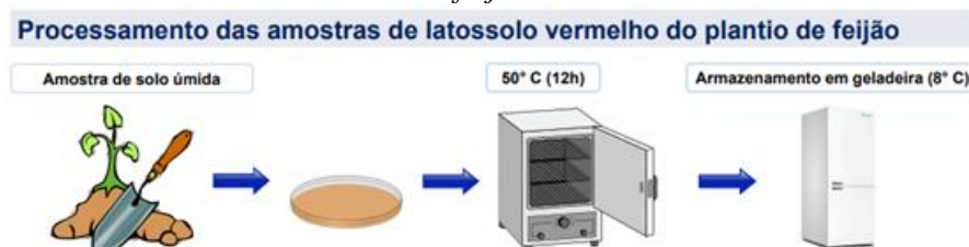
Figura 2. Fluxograma do processamento das amostras de latossolo vermelho destinado ao plantio de feijão.
