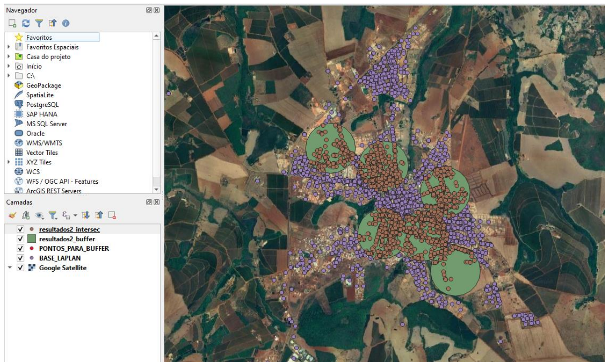
Figura 30 - Execução do Buffer e da Interseção.
