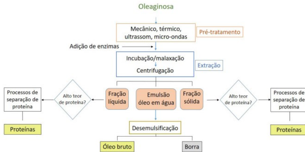
Figura 9 – Esquema do processo de extração aquosa assistida por enzimas.
