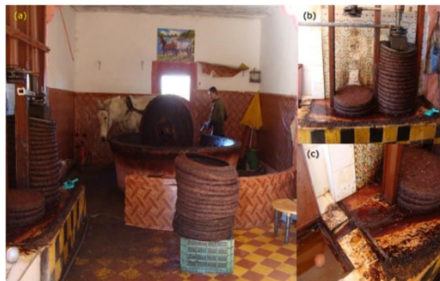
Figura 4 - Processo rudimentar de extração de azeite de oliva em uma localidade rural do Marrocos: (a) moagem com roda de pedra movida à tração animal; (b) filtros confeccionados com palha de tamareira; e (c) escoamento do óleo filtrado.
