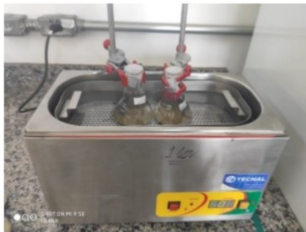
Figura 25 – Processo de extração em ultrassom.
