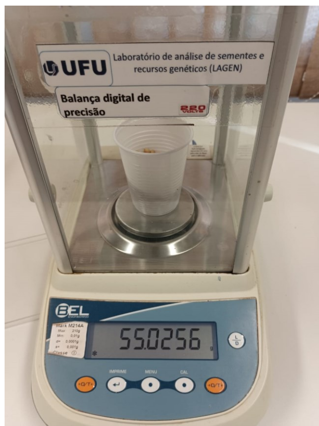
Imagem 4. Balança digital de precisão BEL Engineering, Mark M214A.
