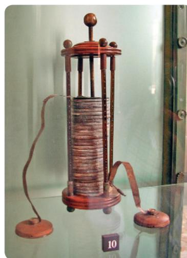
**Figura 3.1** Protótipo da pilha de Volta, constituído por discos empilhados de metais diferentes, separados uns dos outros por pedaços de tecido encharcados em solução ácida e com os discos terminais conectados por fios condutores.
