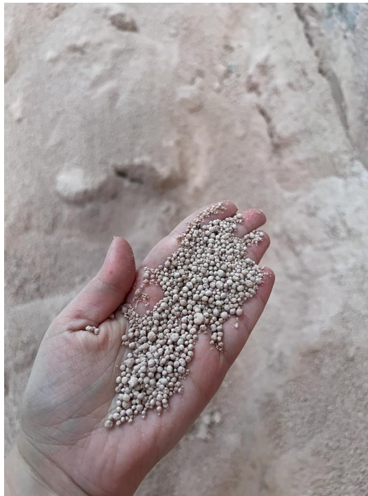
Figura 6 – Ilustração de fertilizante mineral granulado NPK (16.16.16) desintegrado devido à alta absorção de umidade.
