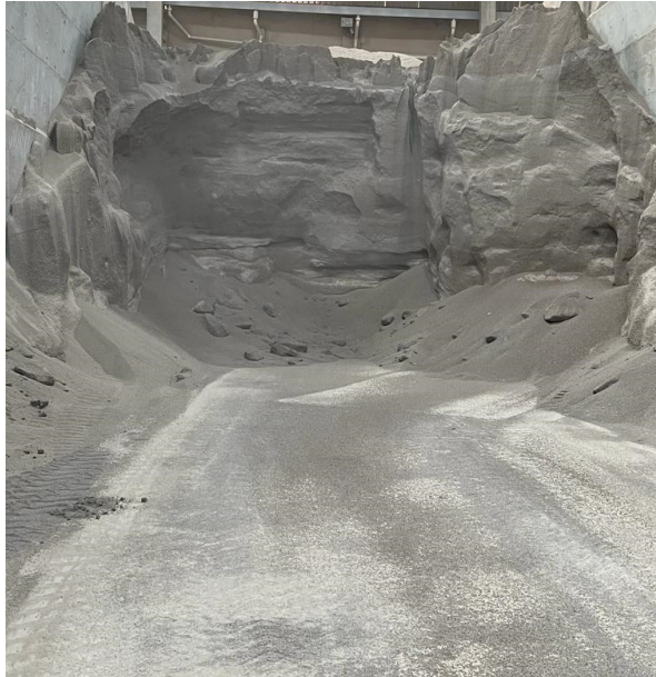
Figura 9 – Representação do paredão formado por pressão na descarga do fertilizante mineral 00.21.00 (13% sol. H_2O ).
