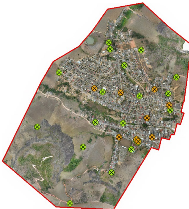
Figura 13 - GCPs e Check Points espacializados na área de estudo
