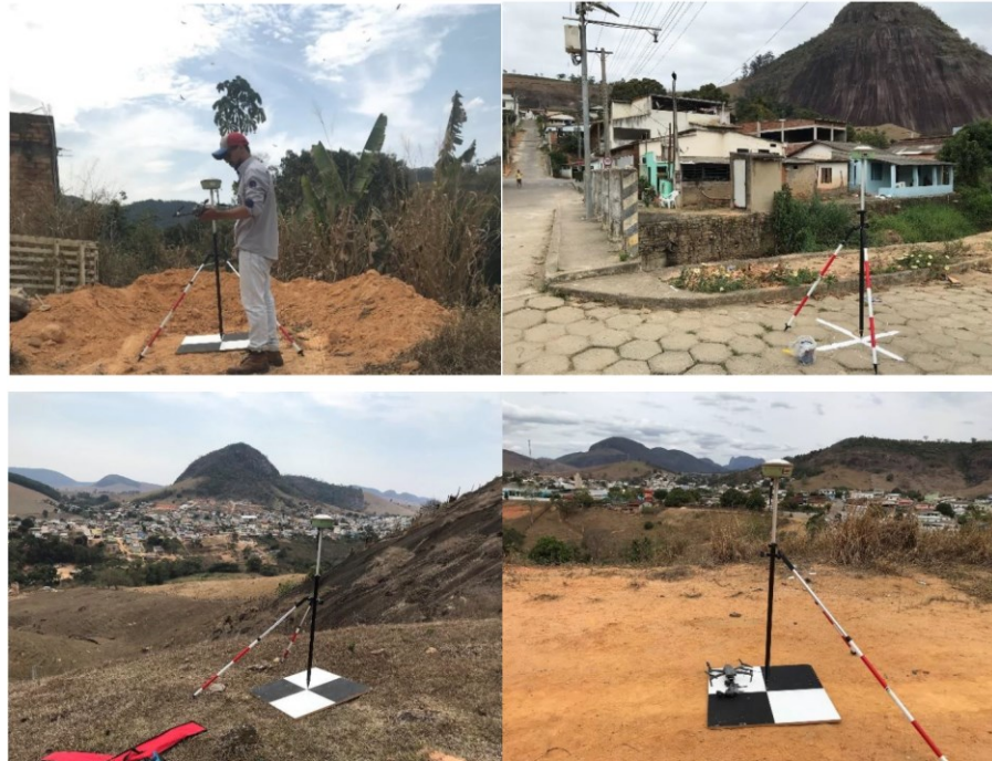
Figura 12 – Coleta de pontos em campo
