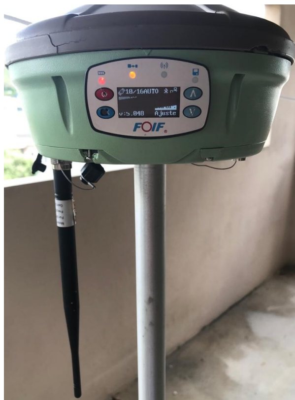
Figura 6 - GNSS A30 RTK
