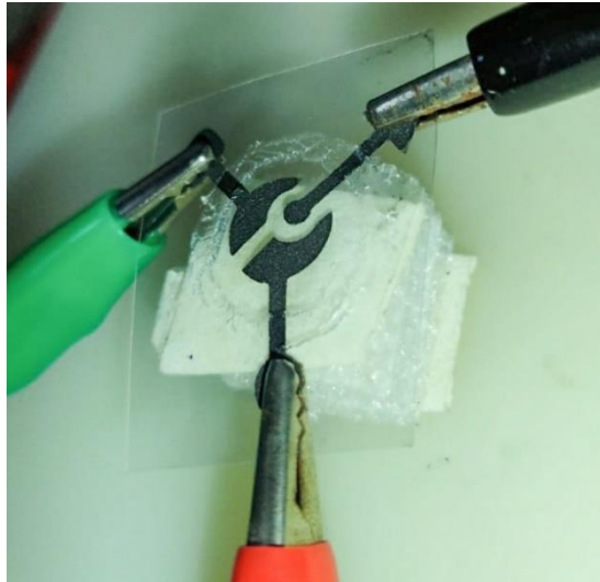
Figura 5. Aparelhagem do sistema eletroquímico para a caracterização dos eletrodos
