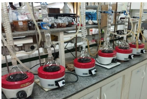
Figura 9: Sistema de refluxo no método de lignina Klason. Fonte: Autoria própria
