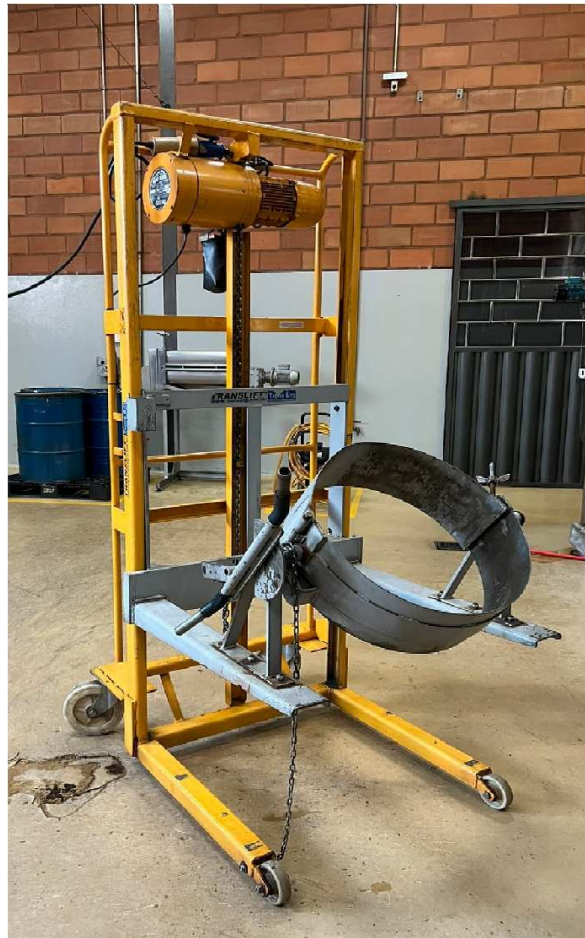
Figura 15 - Equipamento Responsável pela Movimentação do Tambor
