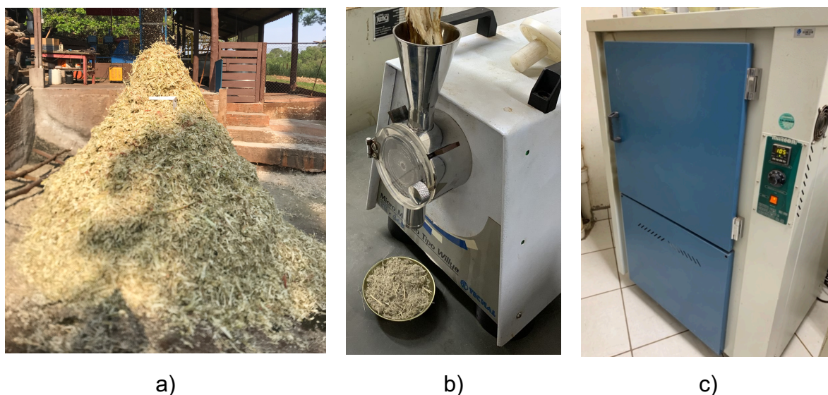
Figura 3.2 – a) Pilha de bagaço onde as amostras foram coletadas; b) Trituração no moinho de facas; c) Secagem em estufa
