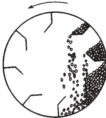
Figura 2.9 – Movimento do leito de sólidos em secador rotativo com suspensores (PERRY e GREEN, 1999)
