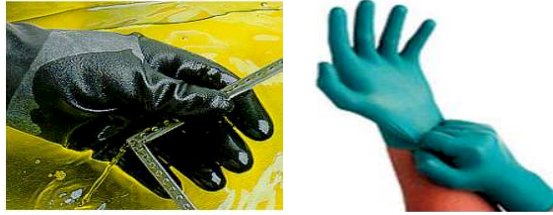
Figura 5 - Exemplo de luva butílica (à esquerda) e nitrílica (à direita).
