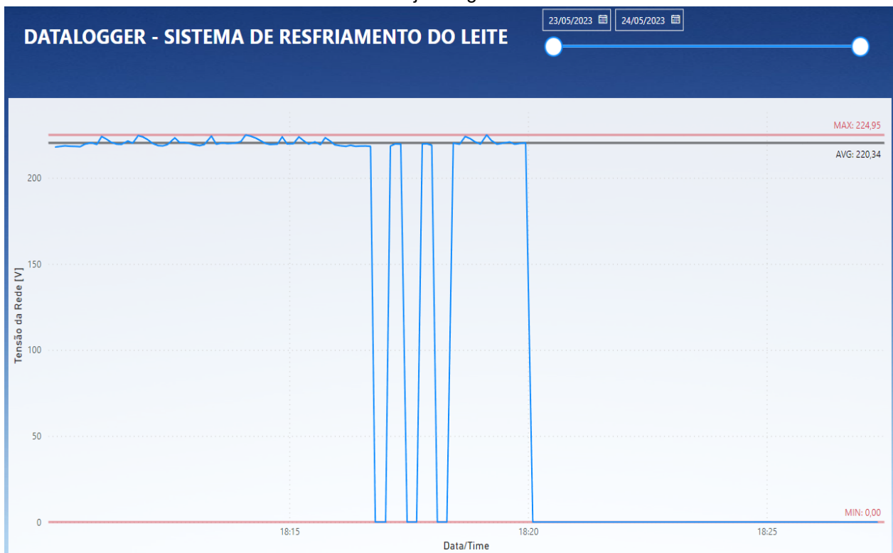
Figura 19 - Representação gráfica de dados registrados pelo datalogger no momento de chaveamento do disjuntor geral
