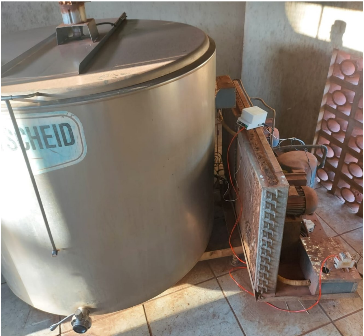
Figura 20 - Datalogger coletando dados de uma unidade refrigeradora
