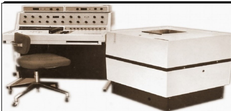
Figura 12. Sistema RMN antigo (década de 1970): 60 MHz ( B_0 = 1,41 Tesla = 14100 Gauss), (RMN de Onda Contínua com Eletroímã).
