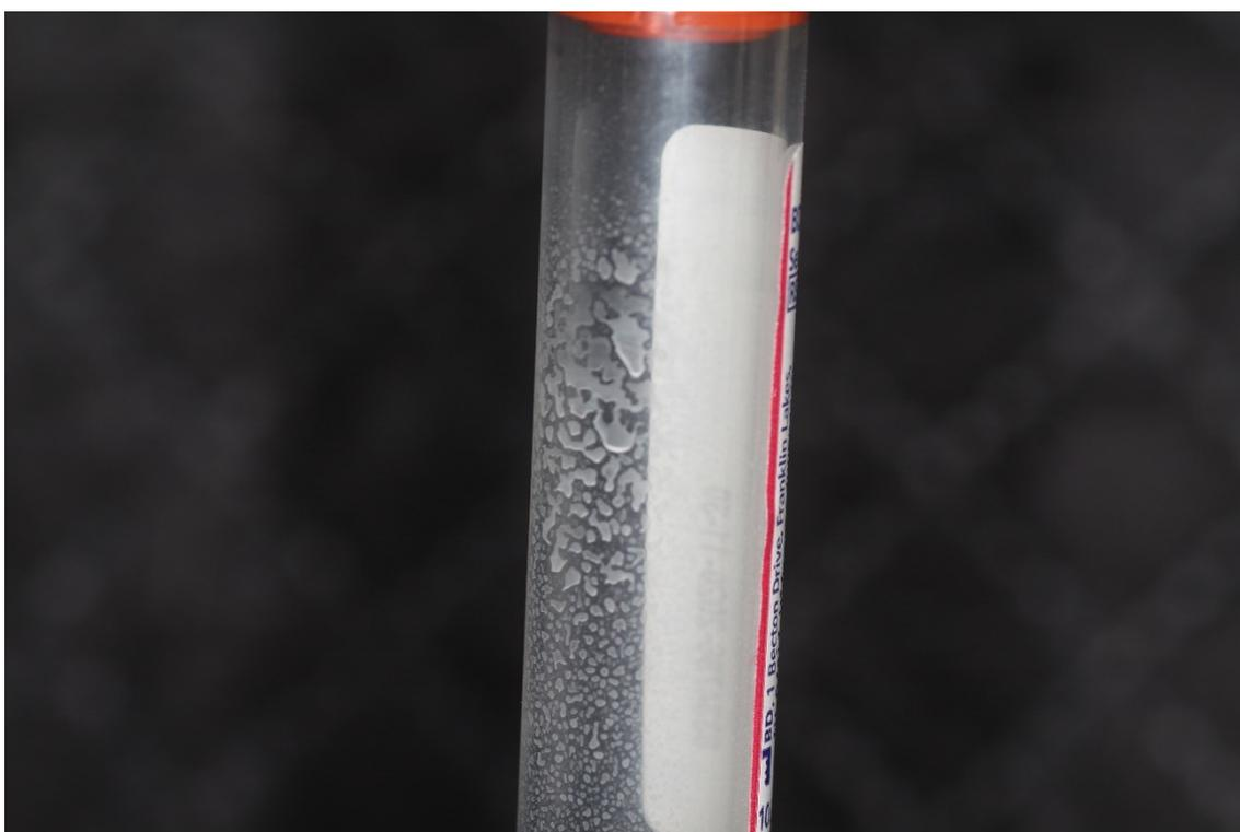
**Figura 5:** Imagem de tubo de plástico revestido com sílica
