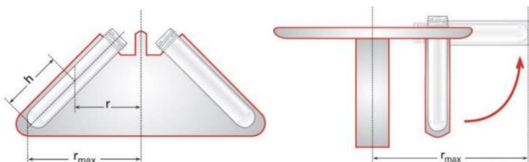
**Figura 8:** Desenho esquemático comparando centrífuga de ângulo fixo (à esquerda) e basculante (à direita); raio em relação à região média do tubo ( $r$ ); raio em relação ao fundo do tubo ( $r_{max}$ ); comprimento do tubo ( $h$ ).
