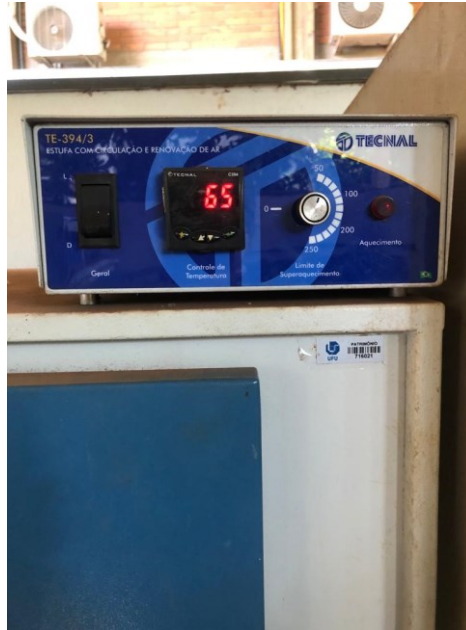
Figura 7. Amostras acondicionadas em estufa de circulação e renovação forçada de ar a 65°C.
