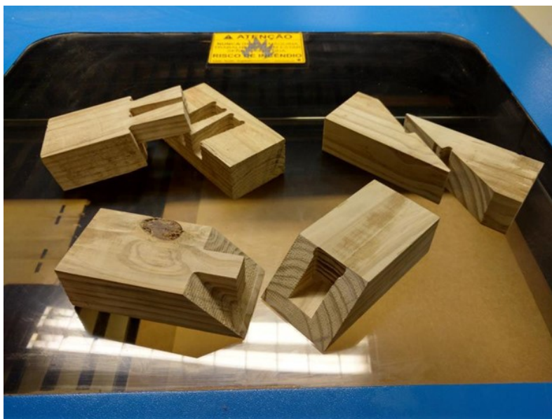
Figura 10 – Fotos de encaixes produzidos
