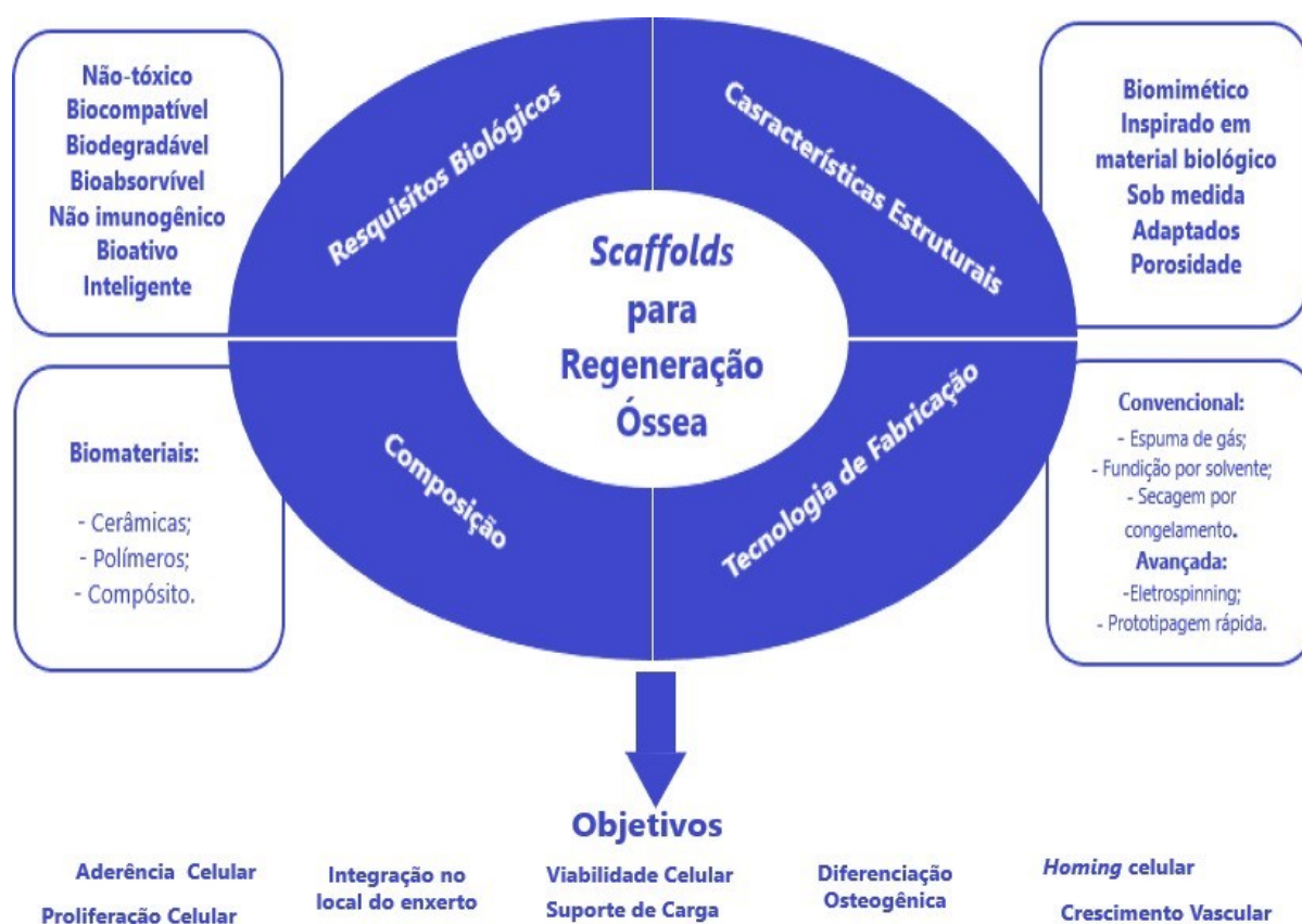
Figura 2 – Propriedades que um scaffold ideal deve ter para ser aplicado com êxito na Engenharia de Tecido Ósseo. Estão esquematizadas os requisitos biológicos, características estruturais, tecnologias de fabricação e composição de biomateriais. Requisitos Biológico: atóxico, biocompatível, bio absorvível, biodegradável, não-imunogênico, Bioativo e “inteligente”. Características estruturais: Biomimético, inspirado nos sistemas biológicos, feitos sob medida, adaptados, porosidade elevada e interconectada, propriedades mecânicas e topografia propícias a adaptação e favorecendo os processos biológicos. Tecnologias de fabricação: Espuma de gás, fundição por solvente, Secagem por congelamento, Eletrospinning e Prototipagem rápida. Composição: Cerâmicas, polímeros e compósitos. Na parte inferior do esquema temos os
