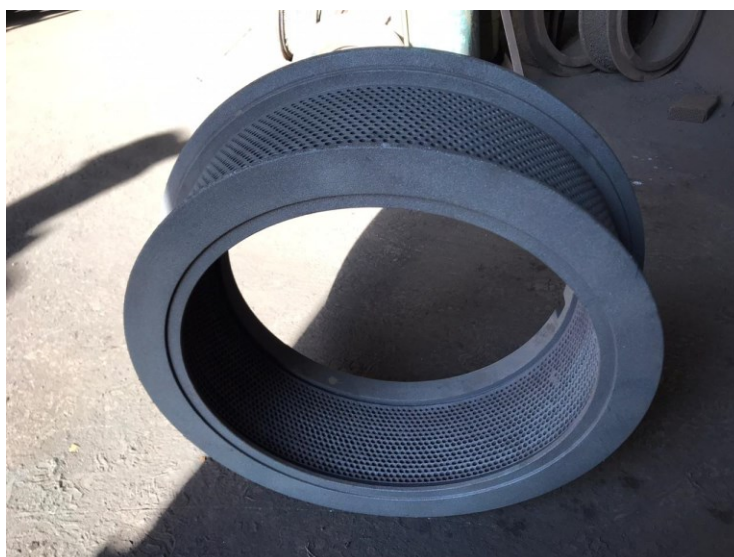
Figura 9. Matriz de peletização vertical de fertilizantes organominerais. Fonte (autoria própria, 2020).
