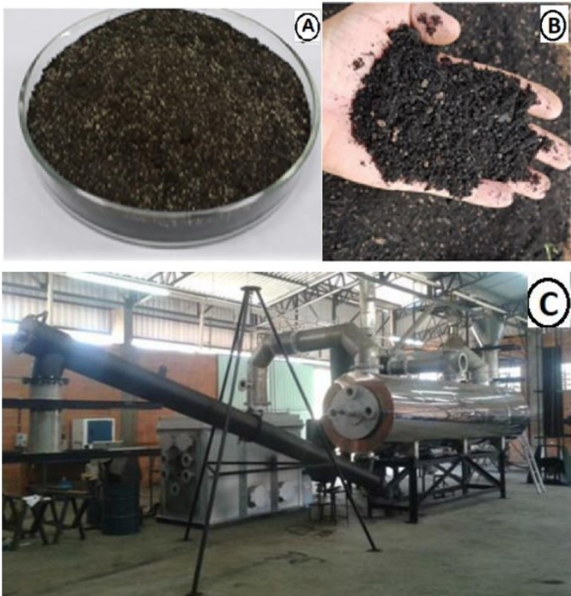
Foto 1. Organomineral farelado a base de torta-de-filtro (A); Organomineral farelado a base de Biochar (B); Reator de Pirólise utilizado para produção do Biochar (C). Fonte (Rosa, 2017).
