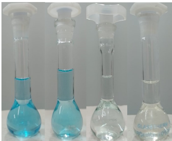
Figura 19. Soluções com diferentes concentrações de indofenol após o borbulhamento da amônia por 60, 30, 20 e 0 minutos, respectivamente, diretamente em solução.
