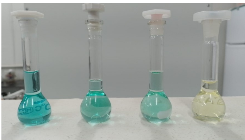
Figura 22. Soluções com diferentes concentrações de indofenol após a exposição da amônia por 60, 30, 20 e 0 minutos, respectivamente, em papel filtro.
