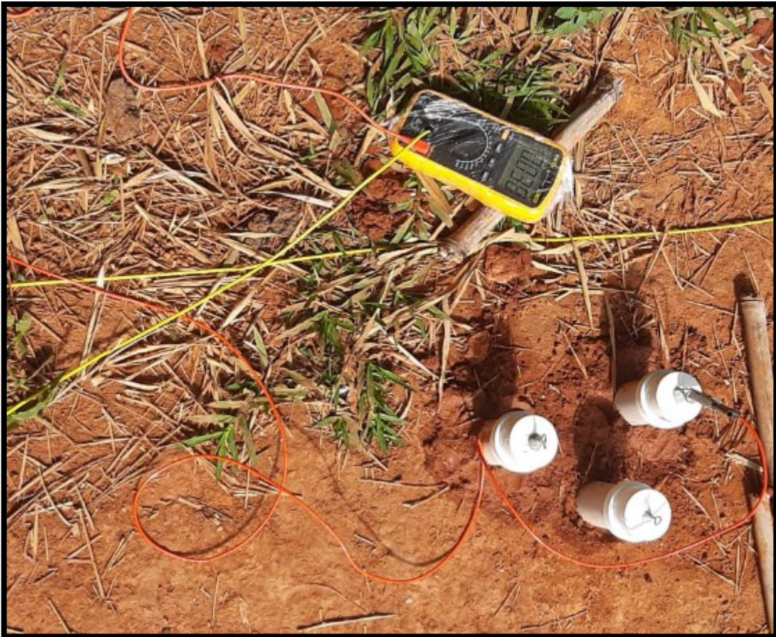
Figura 17. Voltímetro acoplado em um dos três eletrodos do primeiro ponto de teste.
