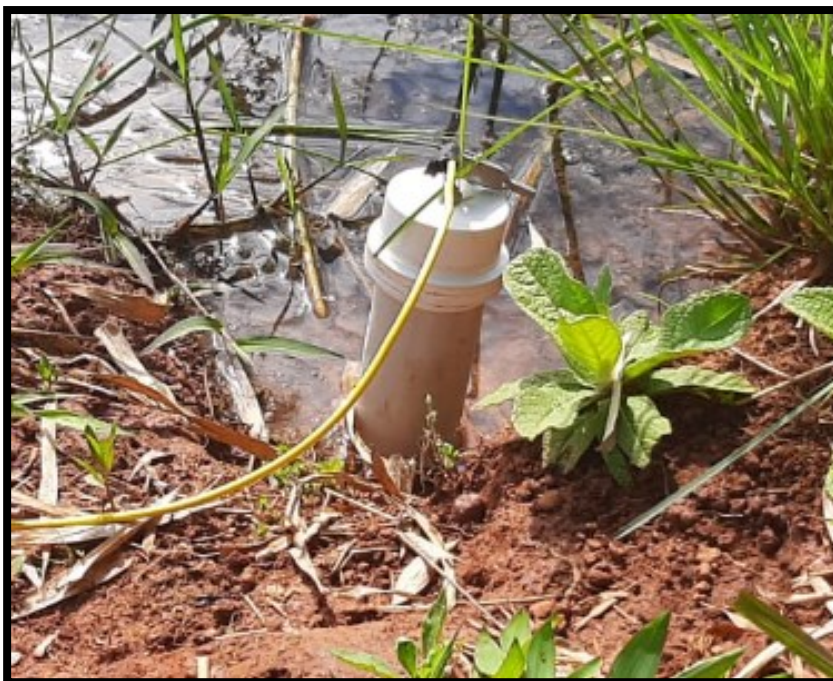
Figura 15. Eletrodo base em contato com superfície aquosa na margem do corpo d'água.
