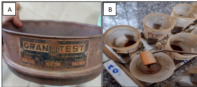
Figura 4: Peneira de 10 mesh (A) e detalhe da retirada de 1 cm 3 das amostras (B).
