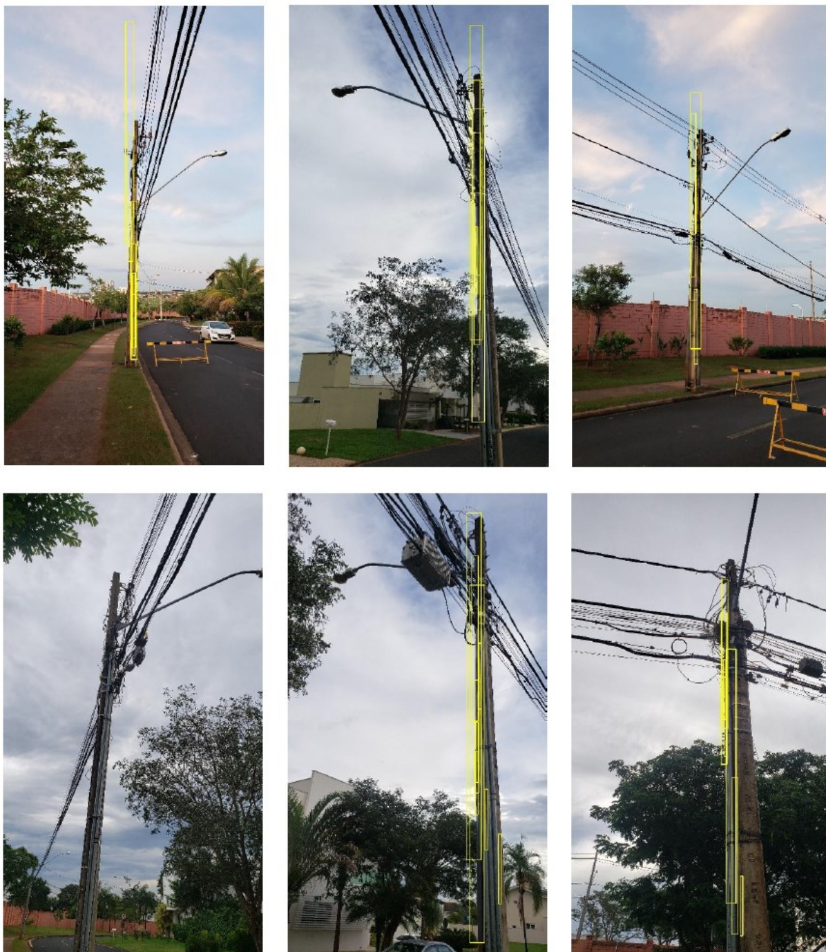
Figura 64: Resultados de reconhecimento de postes após o treinamento 1.
