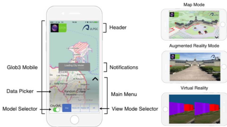
Figura 29: Imagem da aplicação desenvolvida, com os 3 modos de operação.
