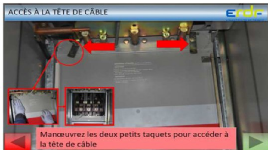
Figura 20: Instruções exibidas automaticamente ao tablet do técnico utilizando Realidade Aumentada.
