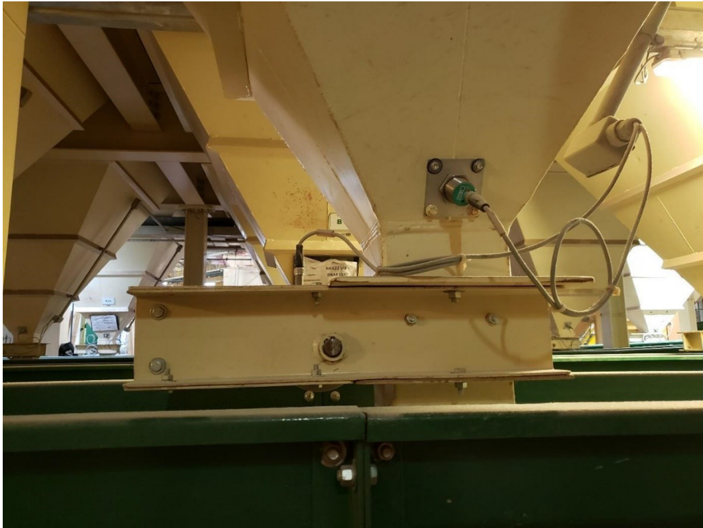
Figura 26 – Sensor de nível mínimo e sensor de abertura de válvula de um silo.
