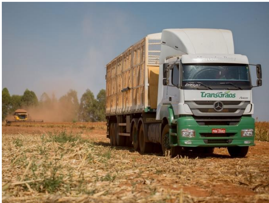
Figura 3 – Caminhão para transporte de espigas, sistema de calandra.
