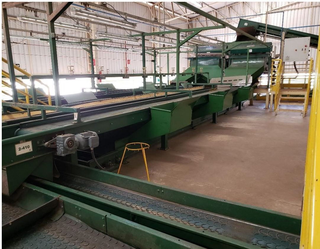
Figura 9 – Mesa de seleção manual e sorter por cor ao fundo.
