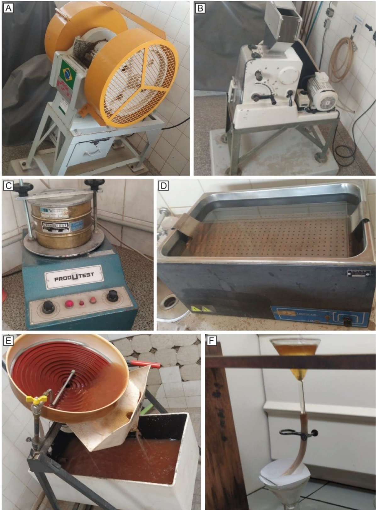
Figura 13 – (A) Britador de mandíbulas de grande porte; (B) Britador de mandíbulas; (C) Mesa agitadora com jogo de peneiras; (D) Cuba ultrassônica; (E) Bateia com rotação automática; (F) Separação de minerais pesados utilizando bromofórmio.
