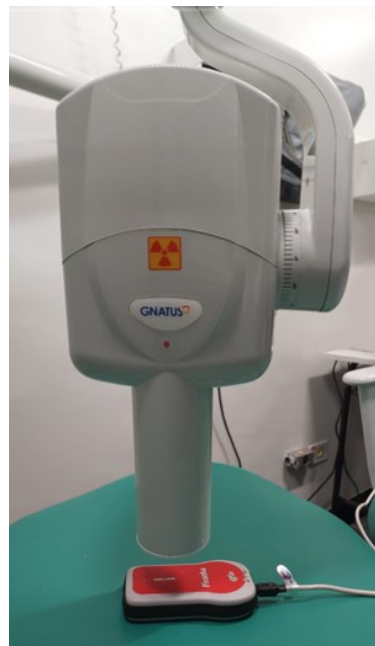
Fig. 13: Posicionamento do detector RED PIRANHA . Figura de autoria própria.
