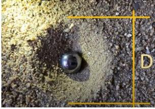
5. Calcule a energia de impacto como sendo sua energia potencial gravitacional inicial  $E = mgh$ , com  $g = 9,79 \text{ m/s}^2$ ,  $h$  sendo a altura de queda e  $m$  a massa da bolinha.
