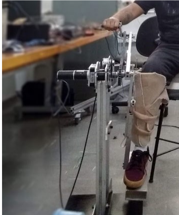
Figura 31- Estrutura de reabilitação combinada ReGear, construída utilizando a metodologia de controle “Assistir quando necessário” (RODRIGUES; MORAES; GONÇALVES, 2019).
