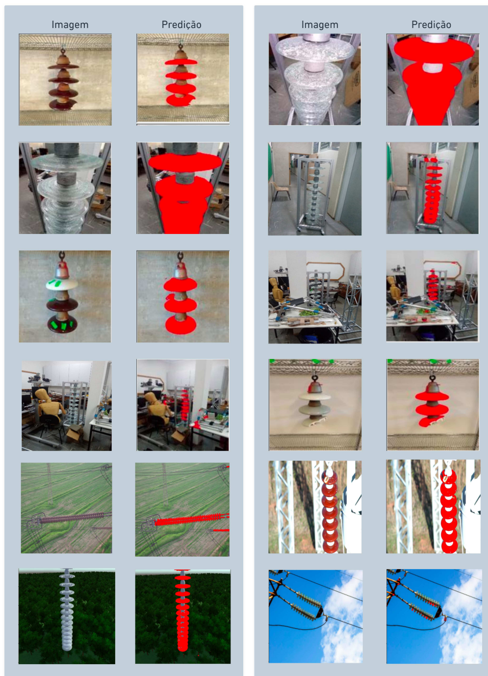
Figura 32 – Predições obtidas em imagens reais com a utilização de uma rede neural treinada com dataset simulado.
