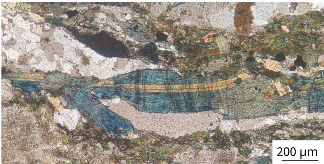
Figura 22. Act com macla deformada e apresentando deformação por torção.
