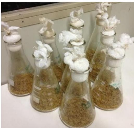
**Figura 3:** Sistema fermentativo FES utilizando farelo de arroz como substrato para *Aspergillus*.
