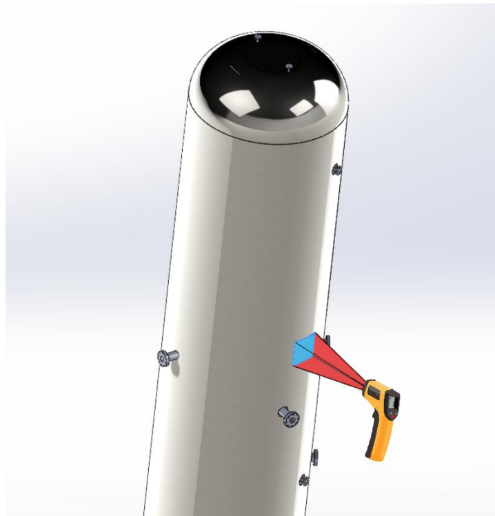
Figura 4 – Representação da medição da temperatura externa no TES com auxílio de um termômetro infravermelho
