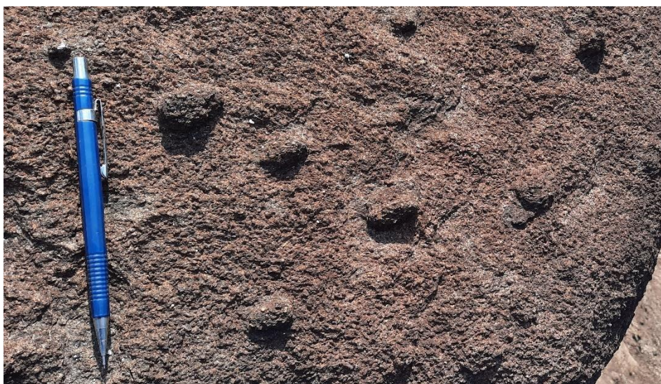
Figura 16- Grt metagranito com fenocristais de granada.
