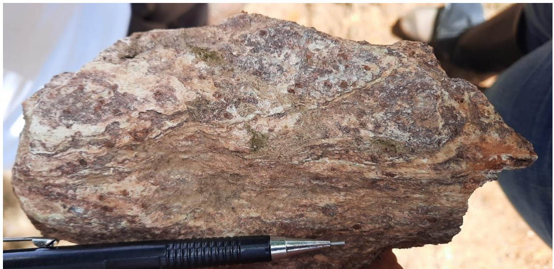
Figura 10- Grt-Ms-Mc-Bt-Pl Gnaiss intemperizado ponto 20
