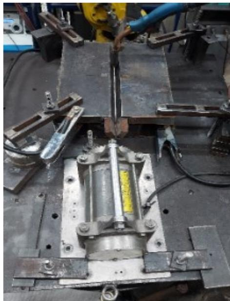
Figura 20. Arranjo eixo do excitador alinhado com o eixo da junta soldada
