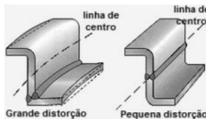
Figura 12. Deposição do cordão sobre a linha neutra como método de prevenção à distorção (adaptado TWI, 1988)
