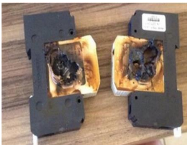
Figura 18: DPS para proteção CA em uso em circuito de CC.
