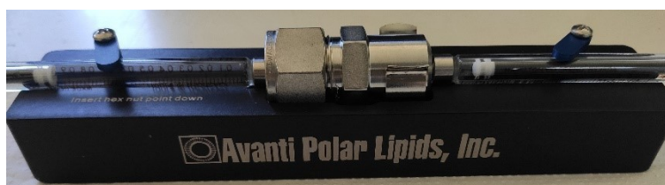
Figura 9 - Mini extrusora da Avanti Polar Lipids para obtenção de lipossomos unilamelares com tamanhos uniformes de 100nm.
