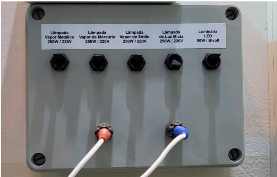
Figura 5.2 - Cargas (lâmpadas) utilizadas na medição.
