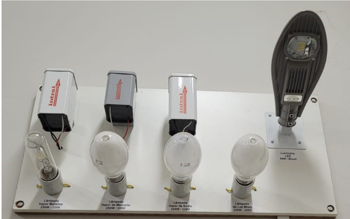
Figura 5.1 – Cargas (lâmpadas) utilizadas na medição.
